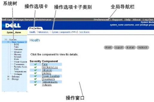
图 3-2 显示具有管理员权限的用户在模块化系统上登录时的 Server Administrator 主页的样式。
